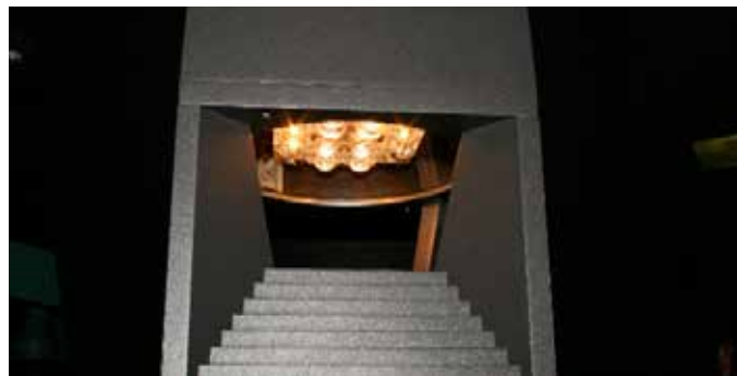
Leuchtenteil mit 8 Hochleistungs-LEDs der Firma Cree
