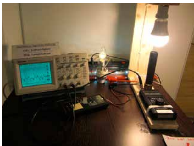
Bild 8. Messaufbau zur Bestimmung der Lichtwelligkeit
