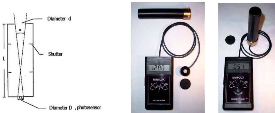
Abb. 20,21,22 Digitalluxmeter „Minilux“ mit Tubus für Leuchtdichtemessung
