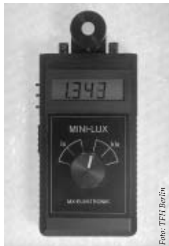
Bild 4. MINILUX mit Photoelement über Messleitung verbunden.
