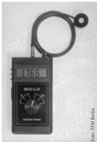
Bild 3. MINILUX mit angebautelem Photoelement.
